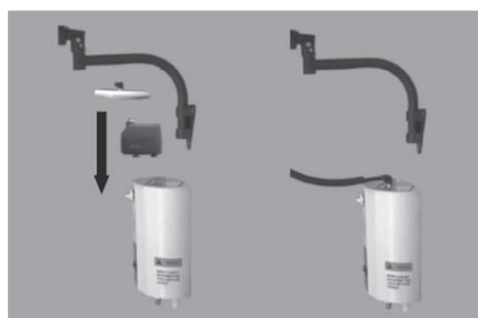
Τοποθετήστε την πλάκα υδρονέφωσης στην πρόσοψη.
